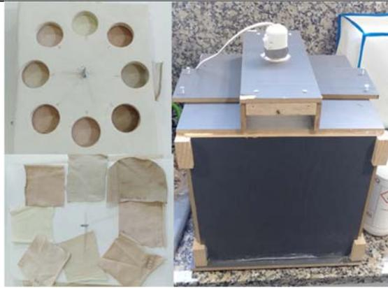
Figura 4: Avaliação do impacto da luz artificial na cor das malhas tingidas (Solidez a luz) construída pela equipa do IPV
