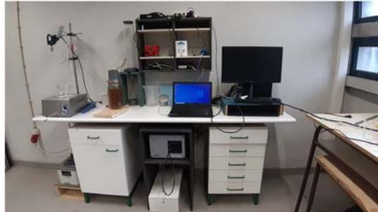
Figura 2: Reator laboratorial com monitorização e controlo por espectrofotómetro NIR na ESTGV
